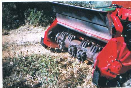
DESBROZADORA TRITURADORA ATILA-ROBOCOP PNB-3 - SISTEMA PREMIADO Y PATENTADO
