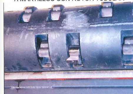
ROTOR TUBULAR A VARILLAS LONGITUDINALES GARANTIZADA LA ROTURA Y FACIL LA EXTRACCIÓN
