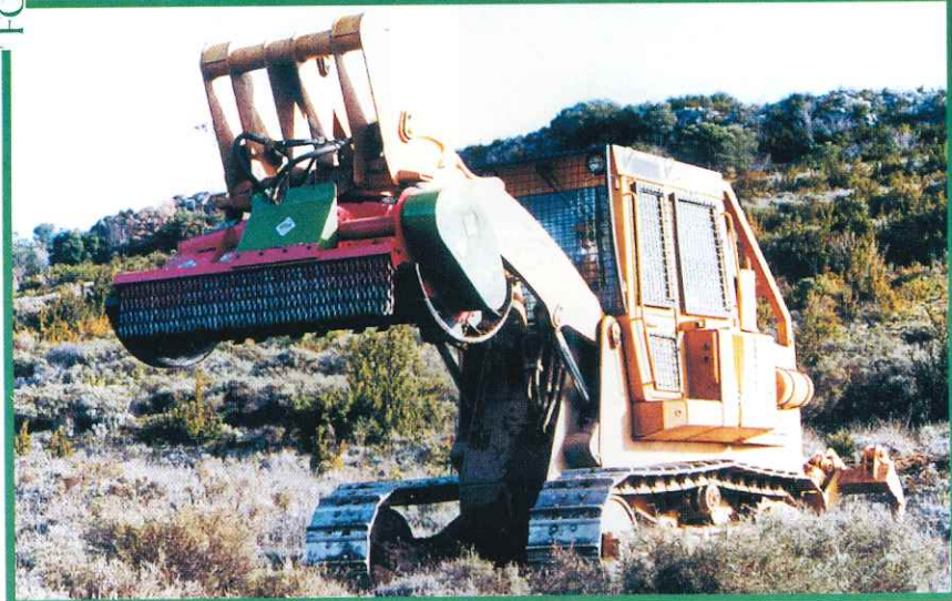
Desbrozadora trituradora forestal hidráulica ATILA® de 1'90 m. de corte real a martillos oscilantes, giro de 360°, sistema 1 a 1 en rotor ( varias patentes ) acoplada a tractora.
