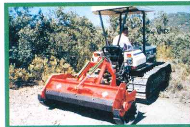
Desbrozadora trituradora forestal ATILA® delantera-trasera, con rotor tubular, bombín compuerta trasera y bombín tripuntal con válvulas de seguridad.
